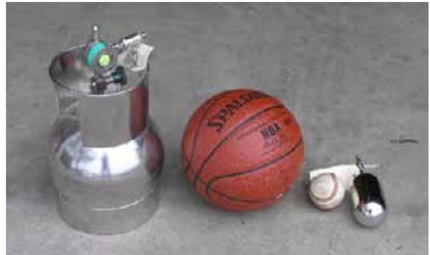
Canisters per il campionamento dell'aria indoor
