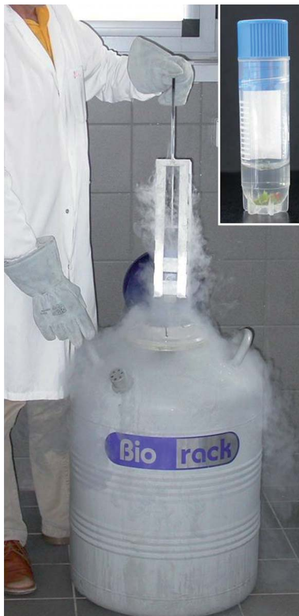
Crioconservazione di apici meristematici. Gli apici, provenienti da coltura in vitro , sono immersi in crioprotettivi all'interno di crioprovette da 2 cc (riquadro in alto) che sono poi conservate immerse in azoto liquido, a -196^{\circ}\text{C} . (Foto Maurizio Lambardi)
