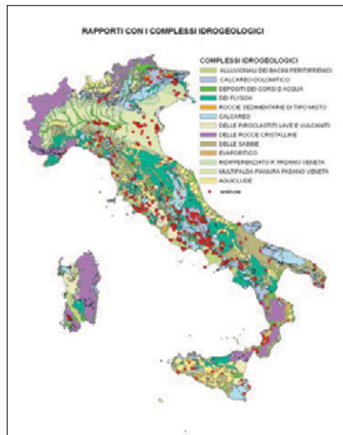
Fig. 10 - Complessi idrogeologici su cui si impostano i sinkholes; la maggior parte dei fenomeni si originano su acquiferi imprigionati.
