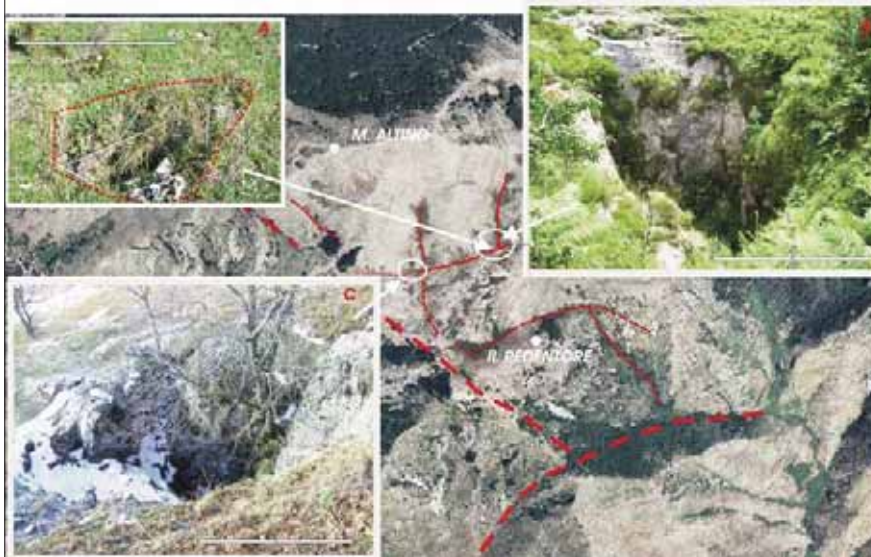
Fig. 5 - Ubicazione delle forme rispetto ad alcuni elementi strutturali nell'area M. Altino - Redentore. In rosso sono indicate alcune faglie significative per questo lavoro. A: la piccola depressione sul prato è di recente apertura ed è posta in strettissima corrispondenza con un lineamento tettonico. B e C [41°18'36,6" N - 13°38'13,5" E]; le foto illustrano due sinkholes aperti nella medesima area.
