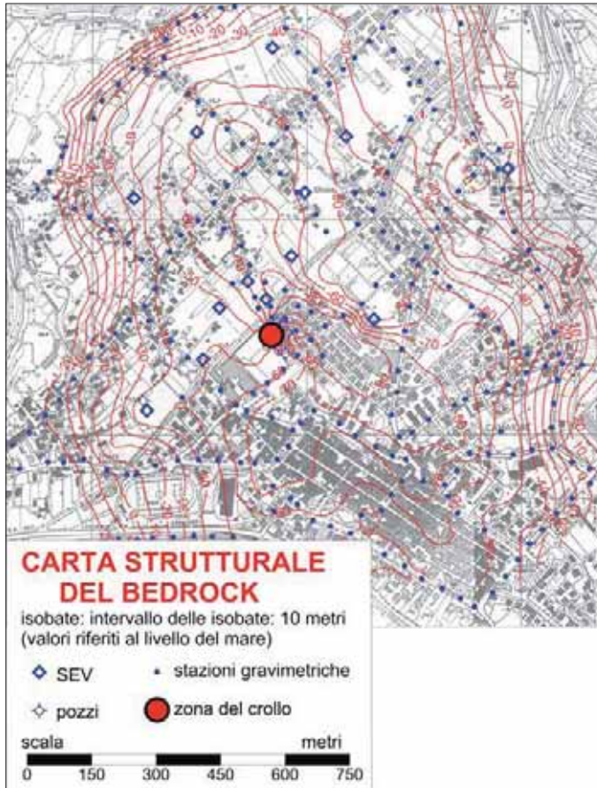
Fig. 2 - Andamento del substrato carbonatico mesozoico nella Conca di Camaiore, i valori delle isobate sono riferiti al livello del mare.
