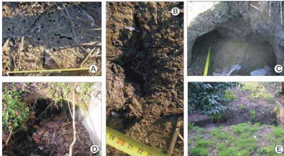
Fig. 7 - Immagini della sequenza evolutiva ipotizzata nella formazione delle cavità: A. Microfori di circolazione attorno ai piani di frattura; B. Zona di parziale depressione; C. crollo della volta ed esposizione dei cunicoli orizzontali; D. Cunicoli orizzontali sul fondo di una cavità; E. solco.
