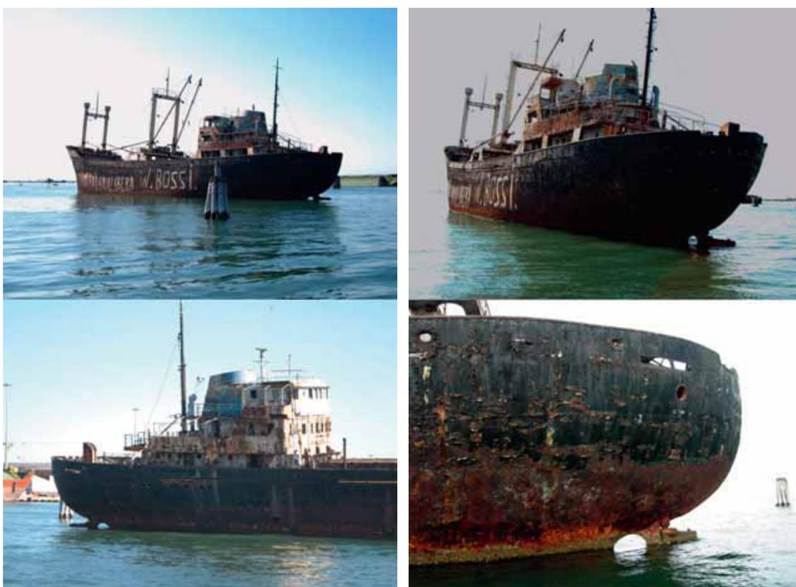
Figura 3-4-7. Documentazione fotografica del mercantile Notios Hellas: evidente lo stato di deterioramento.
