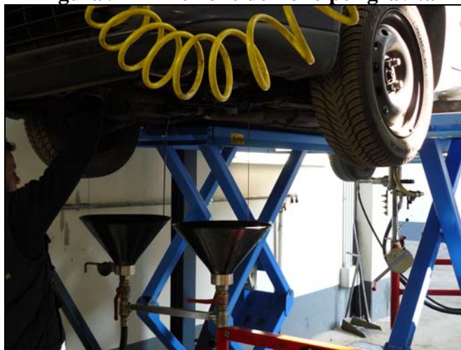
Figura 9 - Rimozione dell'olio per gravità
