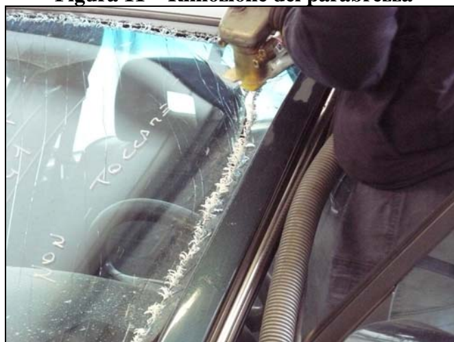
Figura 11 – Rimozione del parabrezza
