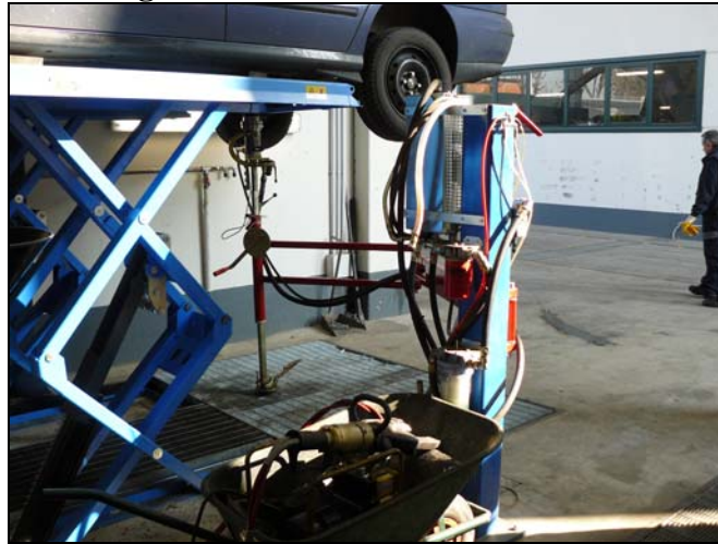
Figura 8- rimozione del carburante
