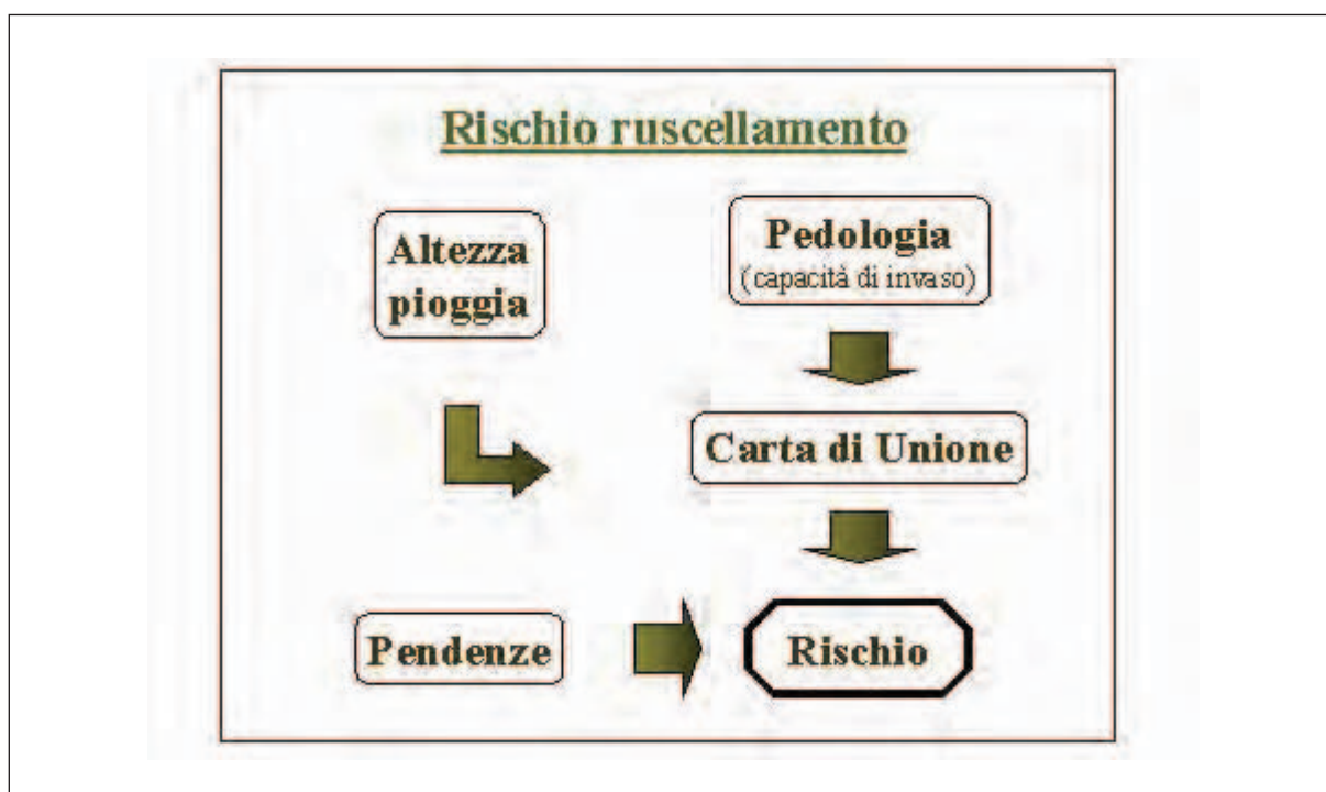
Figura 7.4 – Schema di composizione dei tematismi per la determinazione dei rischi di ruscellamento superficiale.
