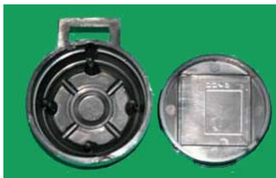
Figura 2.3 - Posizionamento della pellicola CR39 nel rivelatore
