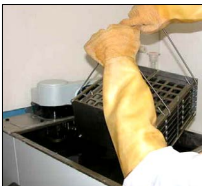
Figura 2.4 – Introduzione delle griglie metalliche contenenti le pellicole CR39
