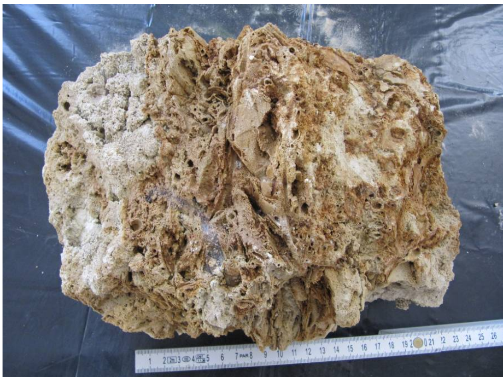
Fig. 62 – Travertino fitoclastico con evidenza di resti vegetali.
