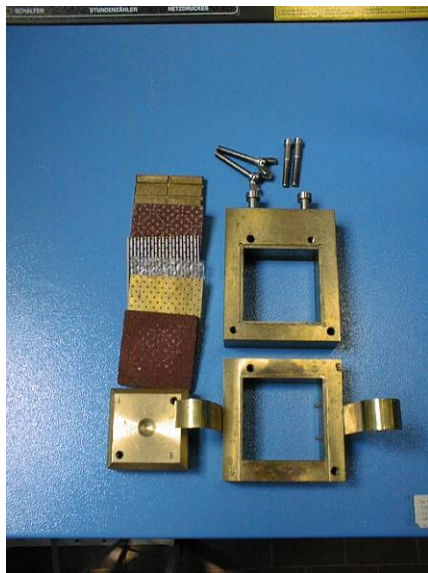
Figura 19: Scatola di taglio e componenti.
