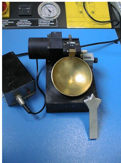
Figura 17: Apparecchio di Casagrande e lama solcatrice.
