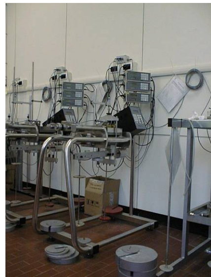
Figura 20: Apparecchio per la prova di taglio diretto
