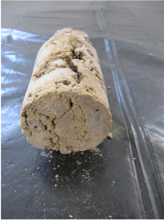
Fig. 66-67 – Esempi di rottura da compressione monoassiale.
