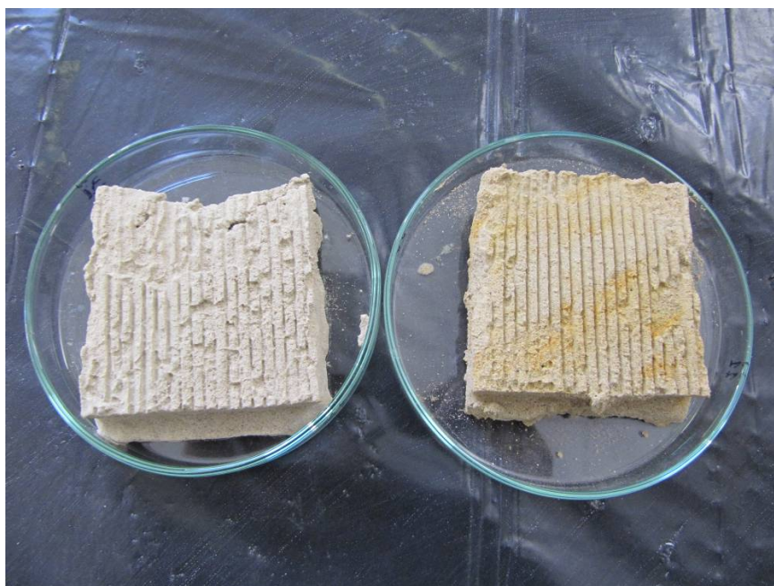
Fig. 21 – Campioni di sabbie dopo la prova di taglio diretto.
