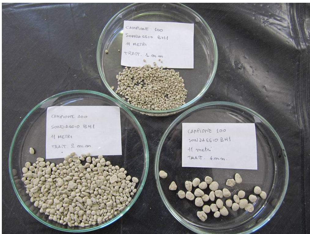
Fig. 41 – Sondaggio BH 1, profondità 11 m, particolare dei trattenuti a 4, 2 e 1 mm.
