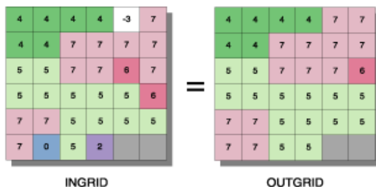
Figura 3-1: funzionamento del Majority Filter .
