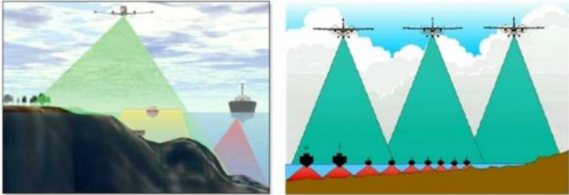
Fig. 2.6. Illustrazione della differente capacità di copertura dei sistemi LiDAR aviotrasportati e dei sistemi acustici montati su imbarcazione. Da Banic and Cunningham (1998) (sinistra) e Guenther et al. (2000) (destra).
