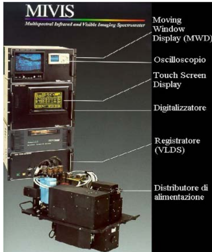
Fig.2.5. Il sensore MIVIS (Sensytech, 2000)
