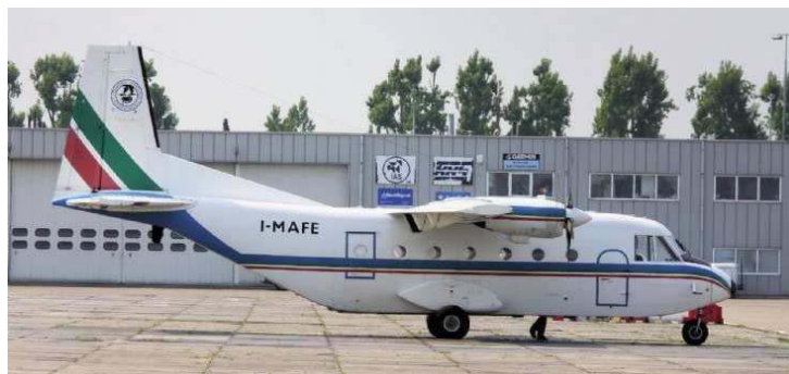
Fig. 2.9 - Aeromobile CGR CASA 212 C utilizzato per la campagna di acquisizione LiDLAZ.
