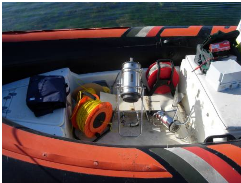
Fig. 2.14. Videocamera subacquea e parte della strumentazione utilizzata sul gommone durante la campagna.
