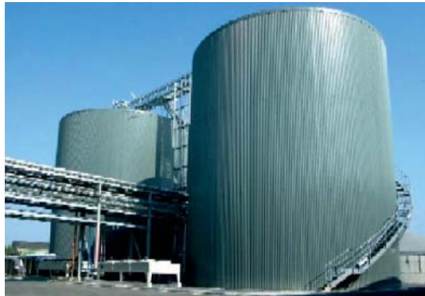
Figura 10. Digestori anaerobici Biotec-BTA; Foto: Biotec Sistemi Srl.
