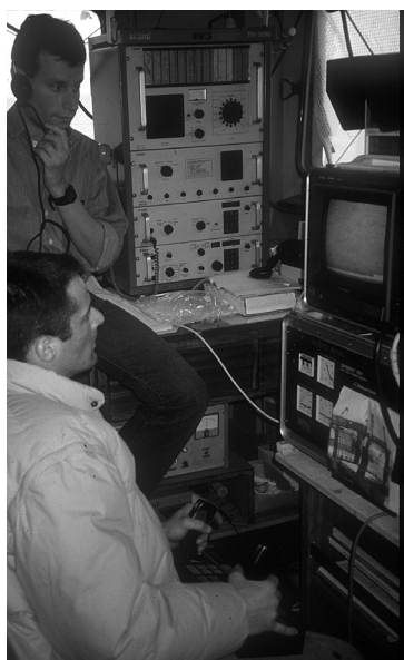
Fig. 5 - Stazione di bordo per il controllo di un veicolo filoguidato (ROV). Il ROV viene comandato per mezzo di una console con joystick e controllato attraverso il video, sui cui possono anche comparire le indicazioni di bussola, profonditàmetro e altimetro.
