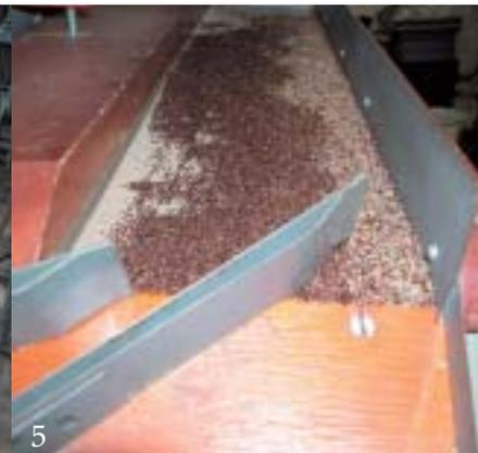
Foto 4 - Tavola densimetrica Oliver Modello 30 DC. Controlli elettronici permettono una serie di combinazioni tra volume d'aria in aspirazione, velocità di alimentazione del seme in entrata, inclinazione del vassoio e frequenza delle oscillazioni che portano alla separazione del seme vano da quello vitale (Foto Georgia Forestry Commission, USA)
