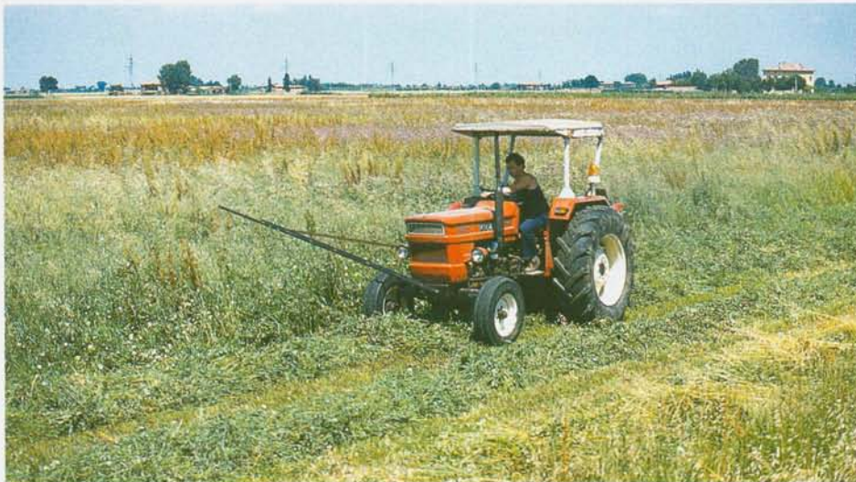
Fig. 60 - L'applicazione di barre scaccia-selvaggina alle macchine operatrici contribuisce a limitare le perdite di nidi in occasione dello sfalcio dei foraggi.
