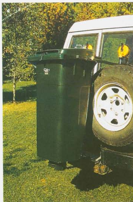
Fig. 52 - Distributore di granaglie auto-portato.
