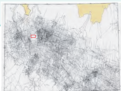
Griglia delle sezioni sismiche acquisite da ENI nel corso della ricerca petrolifera in Pianura Padana centrale. L'area del Foglio Milano è rappresentata in rosso
