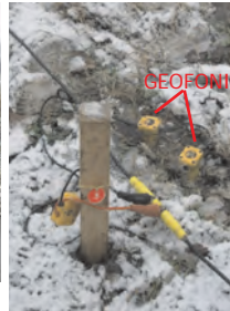
Geofoni e loro stendimento lungo la linea sismica
