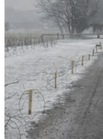
Geofoni e loro stendimento lungo la linea sismica
