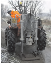
Tramite un maglio il trattore genera le onde sismiche che si propagano nel sottosuolo
