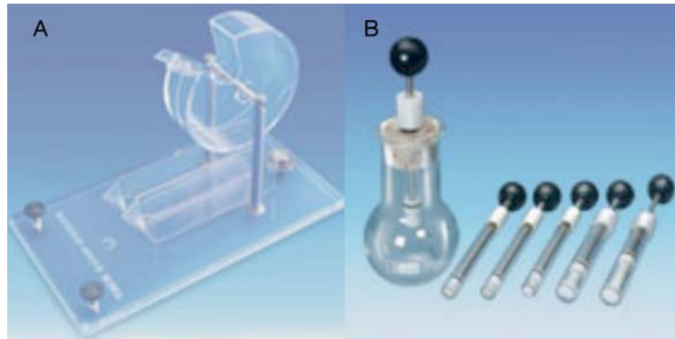
Fig. 8: a) Modello di Folsom plankton splitter b) Modello di pipetta di Stempel (Per concessione di HYDRO-BIOS Apparatebau GmbH)
