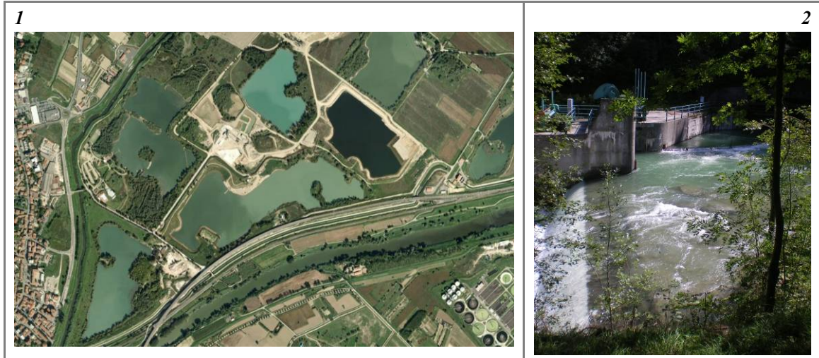
Figura 58 – Altre opere che possono determinare un'alterazione delle portate liquide all'interno di un tratto (oltre quelle definite per A1). (1) Casse di espansione; (2) derivazione.
