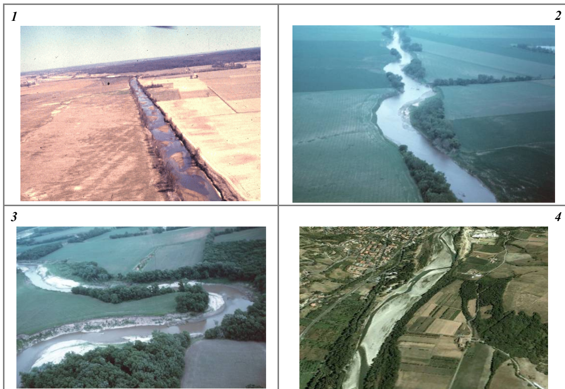
Figura 6 – Esempi di morfologie di alvei semiconfinati e non confinati. (1) Rettilineo; (2) Sinuoso; (3) Meandriforme; (4) Sinuoso a barre alternate.
