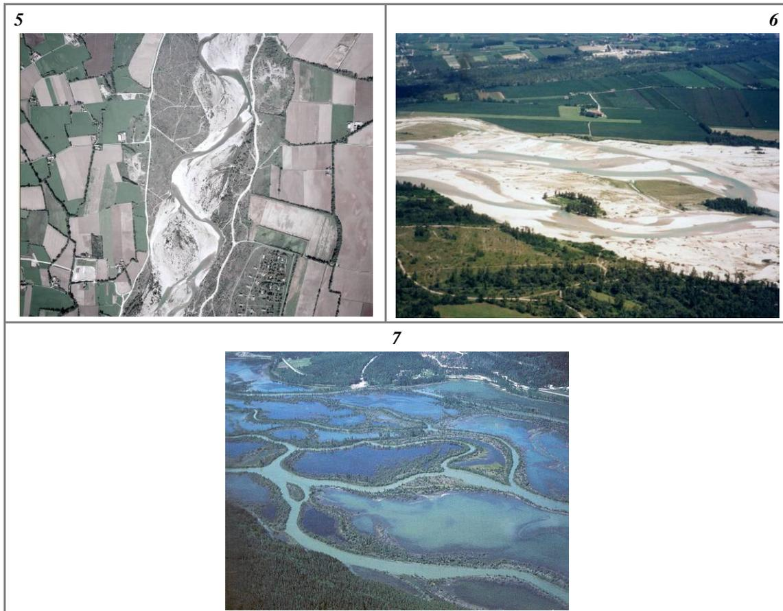
**Figura 6 (segue)** – Esempi di morfologie di alvei semiconfinati e non confinati. (5) *Wandering*; (6) Canali intrecciati; (7) Anastomizzato (le isole e la piana inondabile sono inondate).
