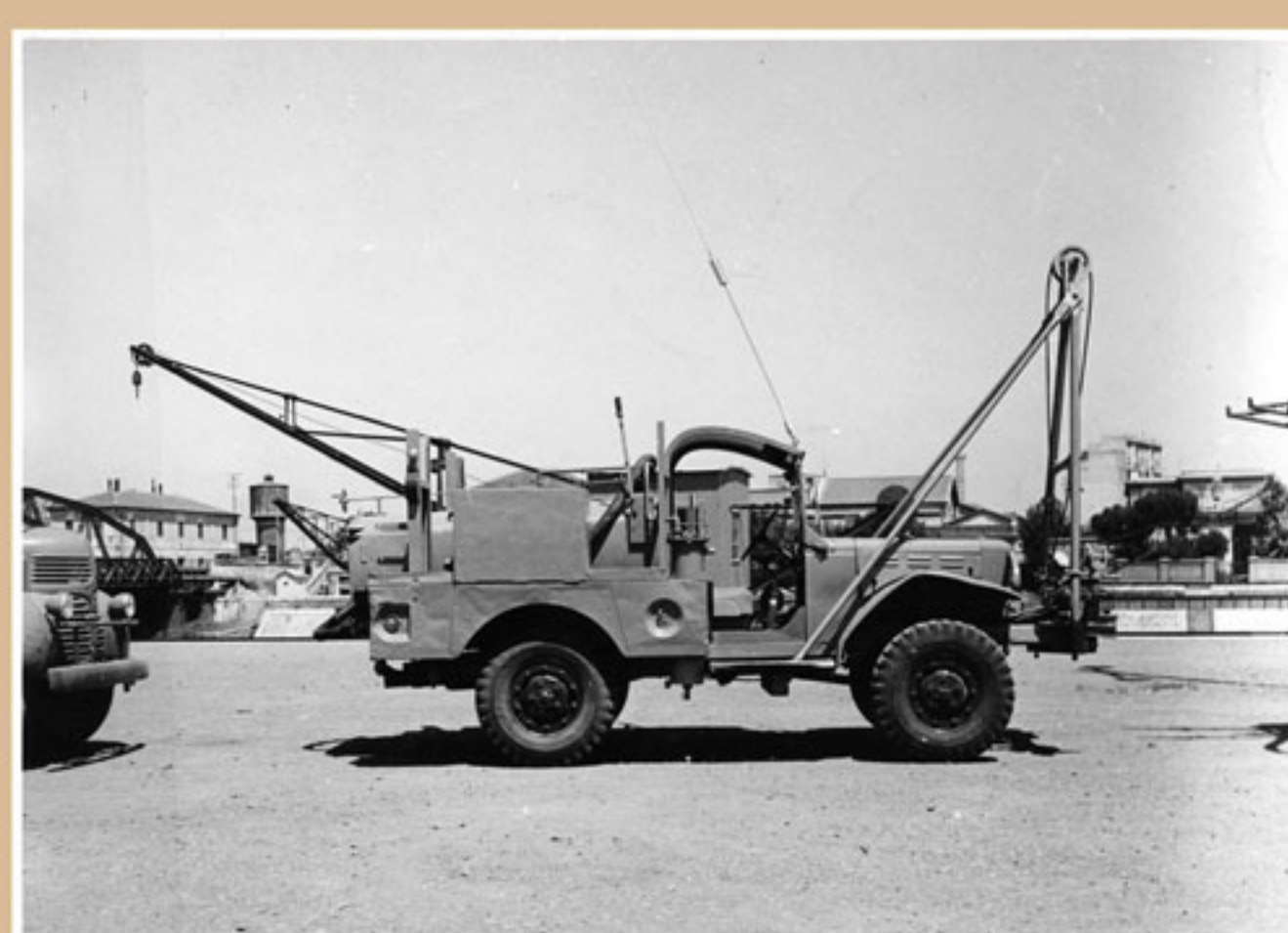
Carro con energizzatore a massa battente per rilievi sismici
