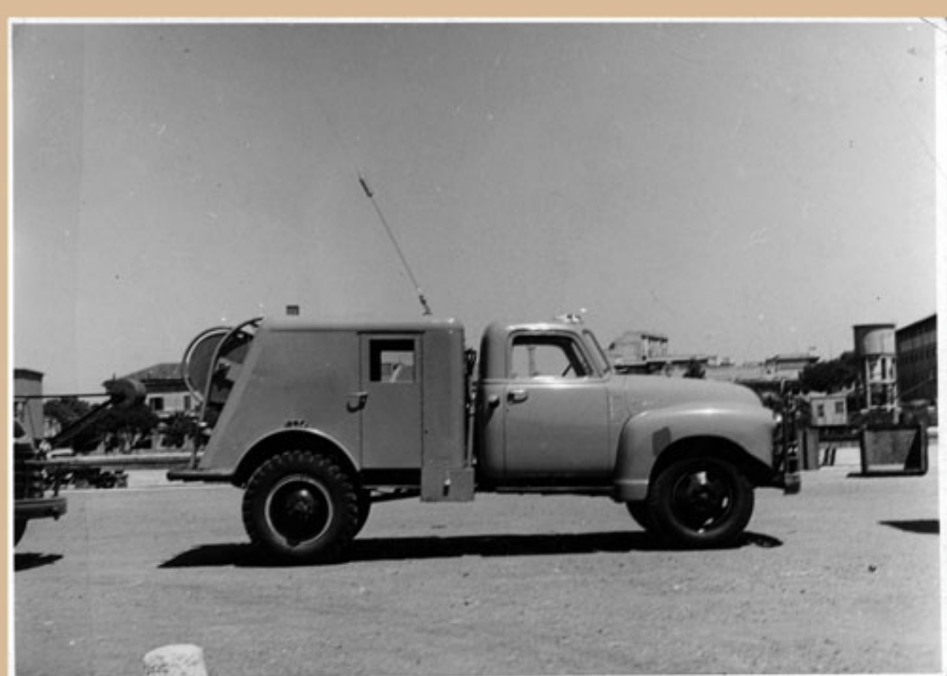
Carro sismico Chevrolet sismografo a bordo 24 canali della NATIONAL GEOPHYSICAL COMPANY anno 1950
