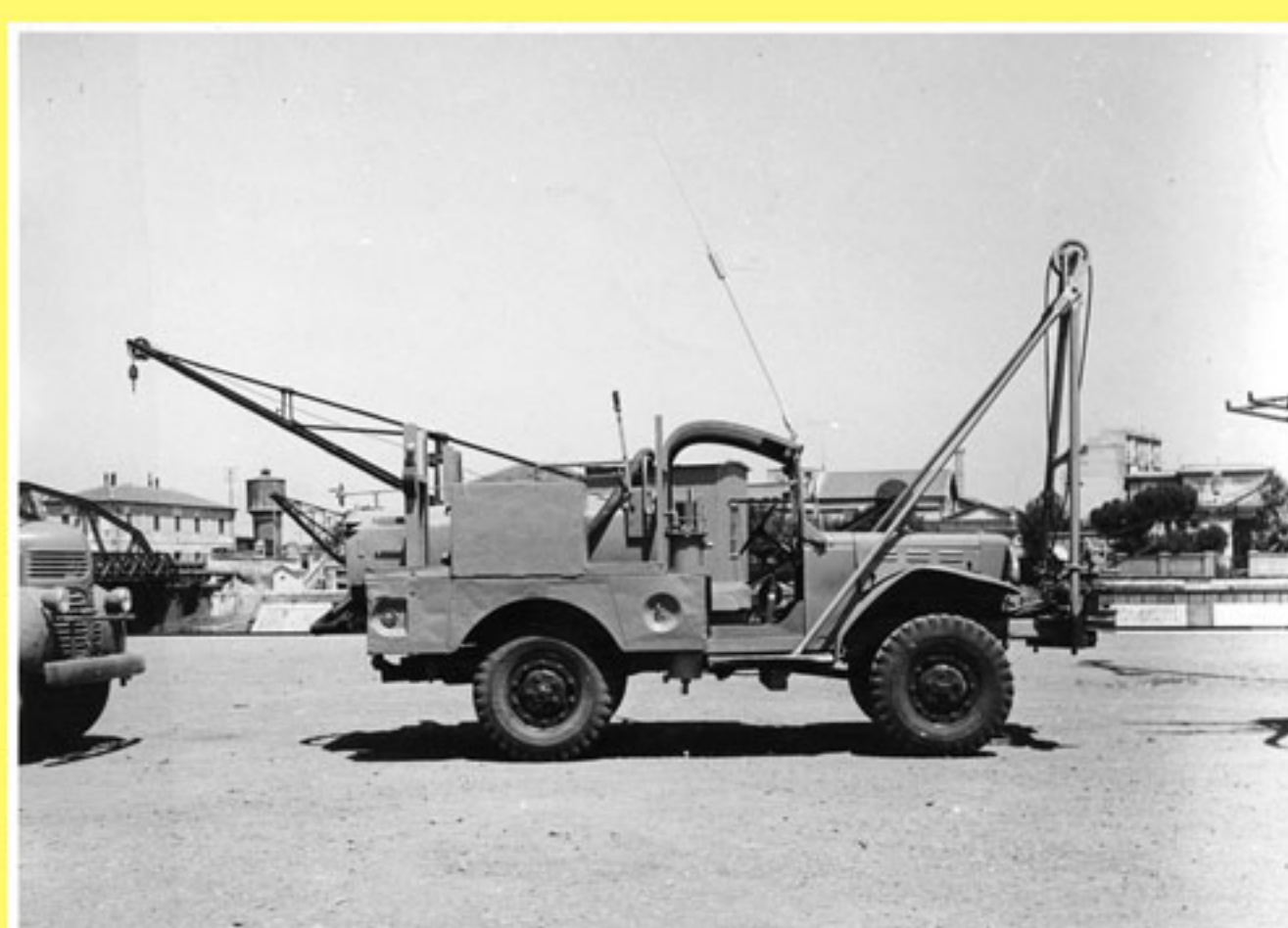
Carro con energizzatore a massa battente per rilievi sismici
