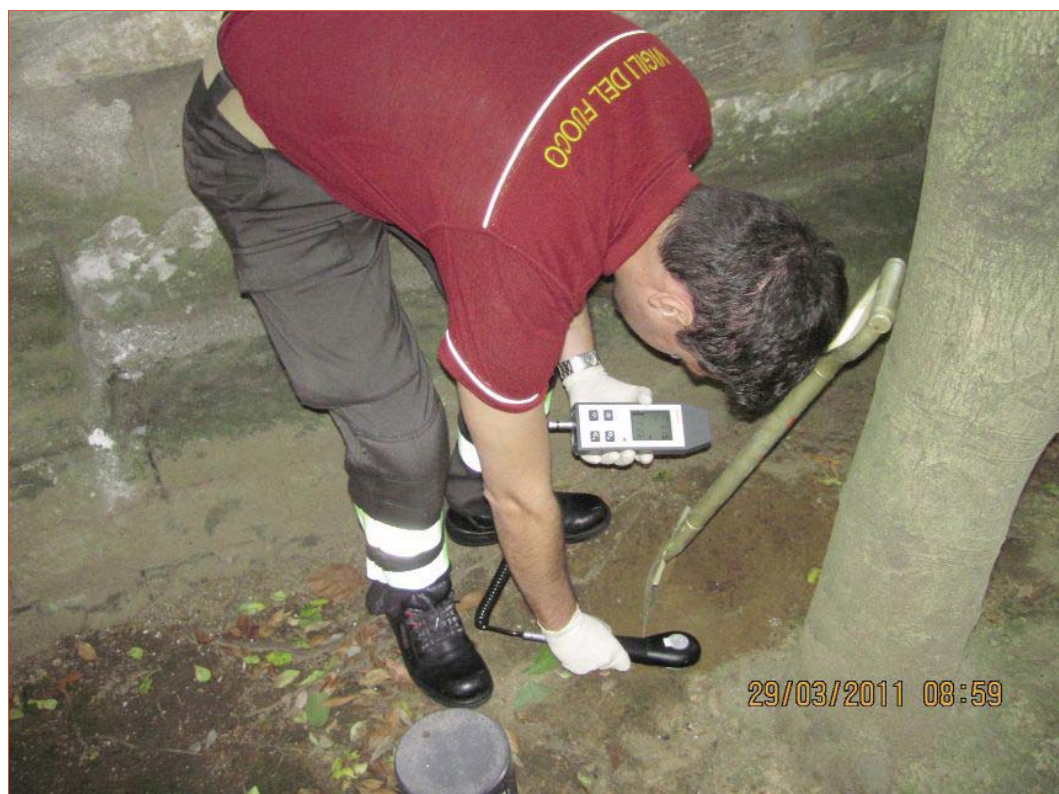
Misure di contaminazione superficiale effettuate con un radiometro (tipo Thermo ESM FH 40 G) con sonda alfa-beta all'interno dell'ambasciata italiana a Tokyo.
