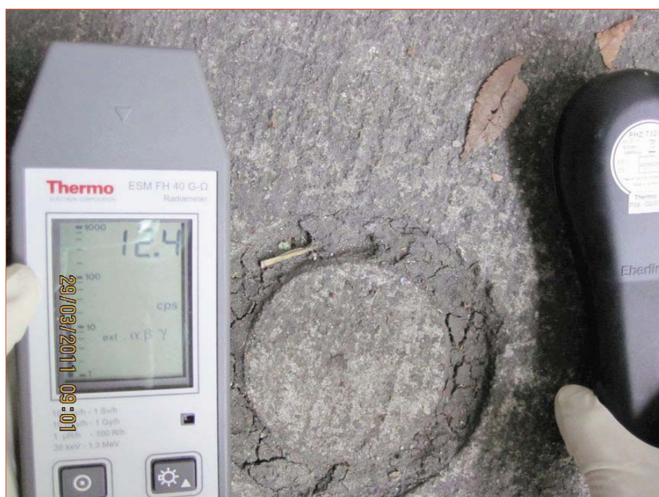
Dettaglio della misura di contaminazione superficiale effettuata sul terreno all'interno del giardino dell'ambasciata con valore misurato dato in cps (colpi al secondo).
