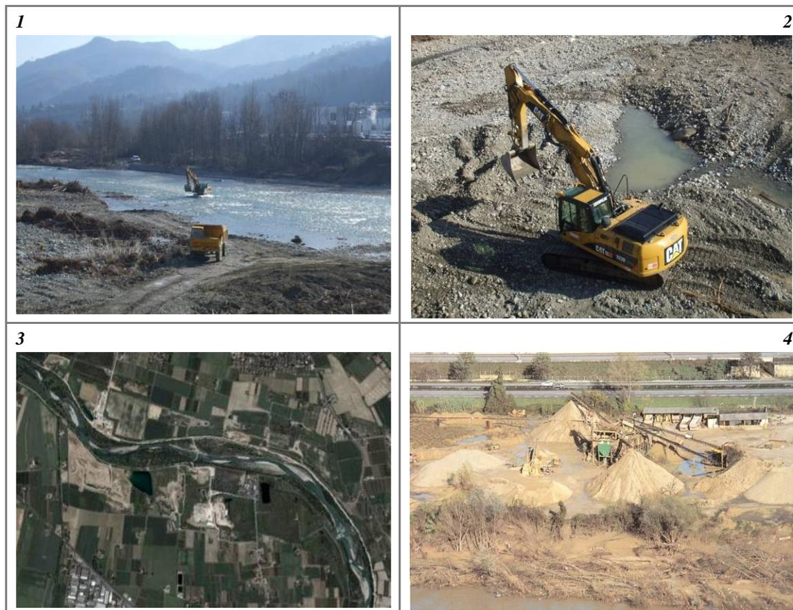
**Figura 75** – Rimozione di sedimenti. (1) e (2) Attività recente o attuale; (3) e (4) indicatori indiretti di intensa attività passata sono la presenza di zone di cava (3) e frantoi (4) e strade camionabili nelle adiacenze del corso d'acqua. L'attribuzione alla *Classe B* o *C* dipende dall'estensione degli interventi (localizzati o diffusi), nel caso di alvei confinati, e dall'intensità dell'attività di escavazione sia in tempi recenti che passati nel caso di alvei semi- e non confinati.
