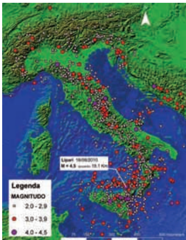
Figura 7.2: Eventi sismici di Magnitudo locale maggior e o uguale a 2, registrati dal 1° ottobre 2009 al 30 settembre 2010 e indicazione dell'evento di Magnitudo maggior e 3
