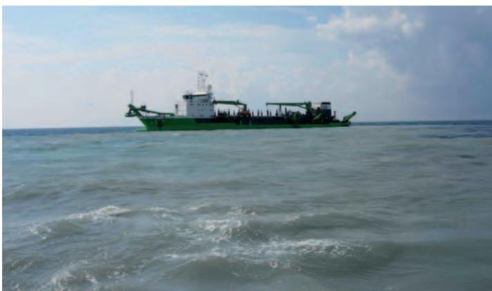
**Figura 9.6: Plume di torbida superficiale generata dalle attività di dragaggio (*overflow*)<sup>12</sup>**
