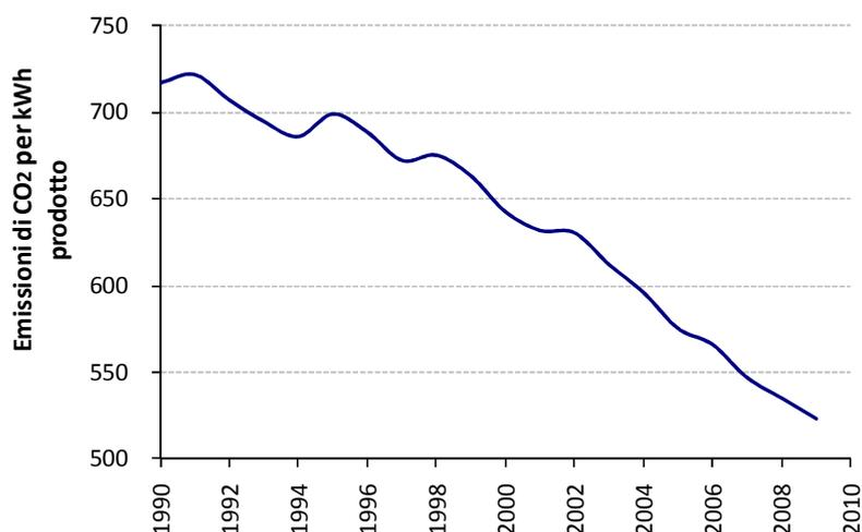
**Figura 1.19** – Andamento del fattore di emissione di CO<sub>2</sub> per kWh elettrico prodotto dal parco termoelettrico.
