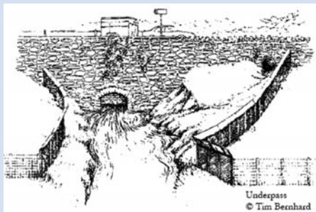
Fig. 29 - Misure di prevenzione della mortalità sulla rete stradale. Da sinistra verso destra: (a) uso di recinzioni e tunnel per evitare il passaggio delle lontra su strade trafficate (per gentile concessione di Tim Bernhard); (b) Passaggio per lontra sotto ad un ponte, in Galles in Wales, UK (per gentile concessione di Geoff Liles). Per ulteriori immagini/video si veda: http://www.otterproject.cardiff.ac.uk/
