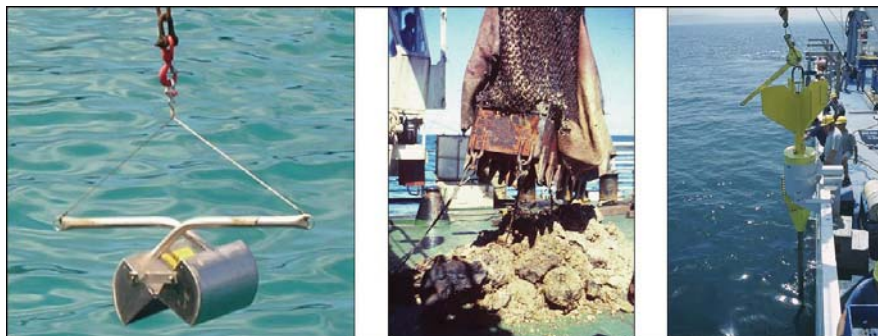
Fig. 9 - strumenti usati per il prelievo di campioni dalla nave: benna, draga, carotiere.
