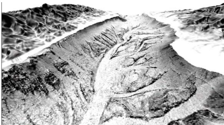
Fig. 6 - Modello digitale del terreno ottenuto dall'elaborazione dei dati Multibeam (F. 601 "Messina-Reggio Calabria, in stampa).
