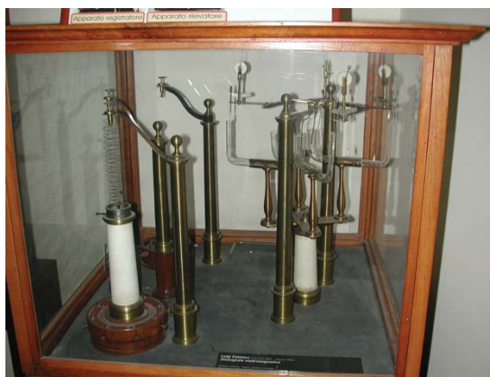
Fig. 11 – Sismografo elettromagnetico di Palmieri.
