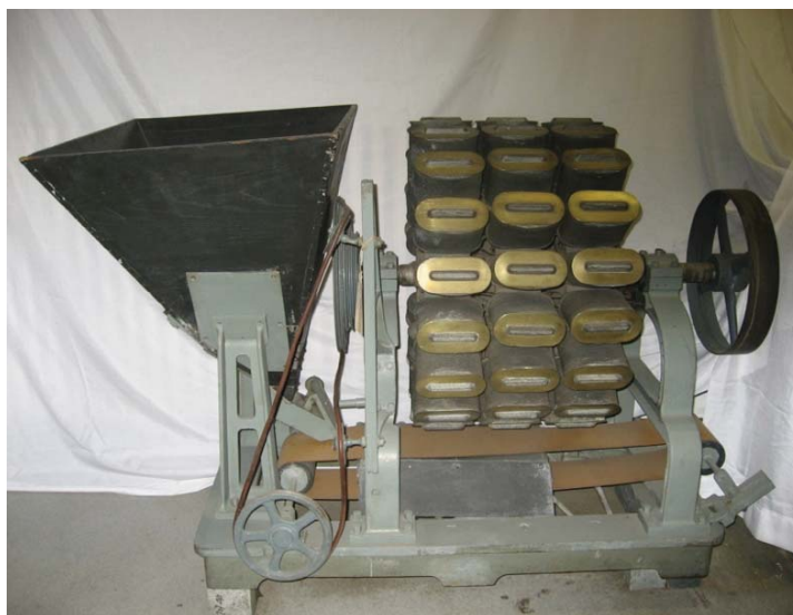
Fig. 5 - Prototipo dell'elettrocernitrice magnetica ideata da Quintino Sella. Il macchinario, rinvenuto nel 1902 presso la miniera di Traversella, è attualmente conservato al Politecnico di Torino [Archivio fotografico Michelangelo Gilli].
