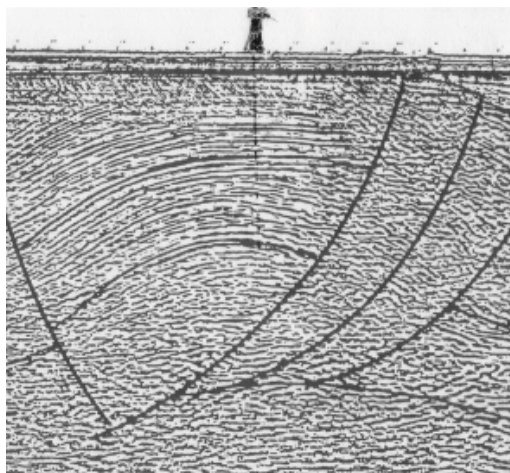
Fig.2 - Sezione sismica a riflessione (1945).
