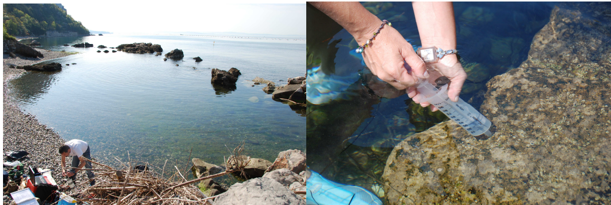
Figura 6.6a (sin) , 6.6b (dx) – Canovella De'Zoppoli, stazione 1166, comune di Duino-Aurisina, provincia di Trieste. Prelievo di campioni di acqua con la siringa secondo il metodo Abbate et al (2010).
