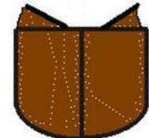
F) Campione non accettabile . Sedimento raccolto disturbato per la fuoriuscita dello stesso dagli sportelli della benna.
