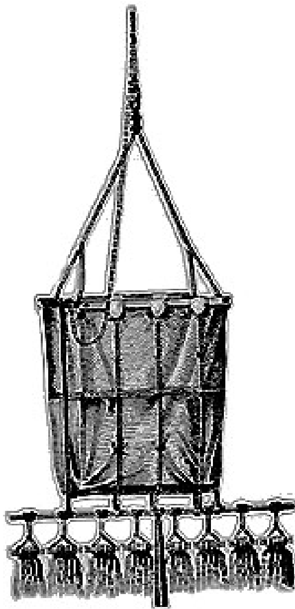
la draga utilizzata dagli scienziati a bordo della “HMS Challenger” per portare a bordo campioni di animali e piante dal fondo del mare
