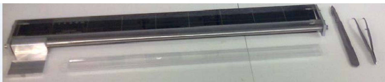
Fig. 4b. Orario di inizio campionamento e taglierina per nastro di campionamento. Esempio di corretto posizionamento e taglio per la suddivisione in porzioni giornaliere di nastro
