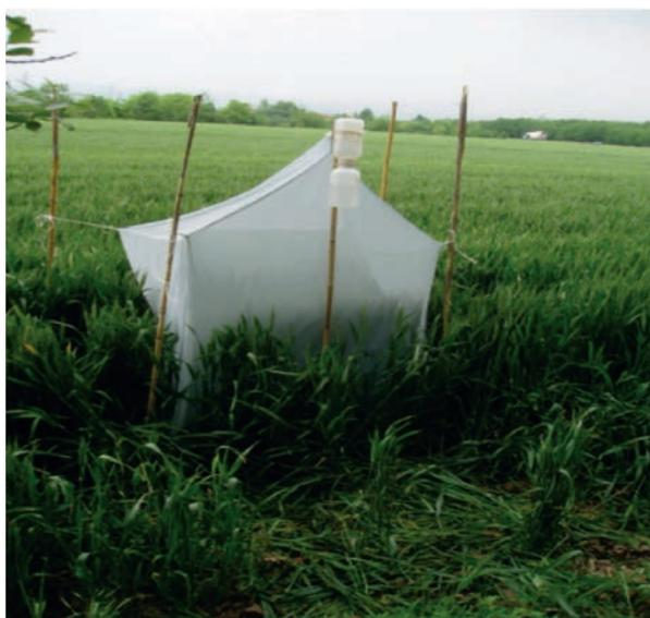
**Figura 2.8** - *Tipo di trappola a emergenza*
