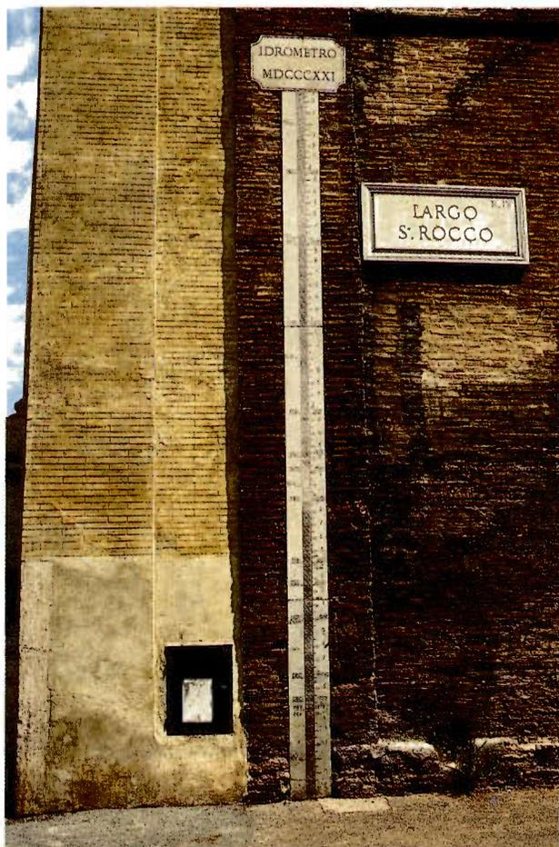
Fig. 31 – Idrometro di Ripetta attualmente situato Largo S. Rocco, sul lato sinistro della Chiesa S. Rocco. Sull'idrometro, installato nel 1821, sono riportati la data e i livelli delle maggiori alluvioni (14) del Tevere con l'indicazione, in metri e centimetri, dell'altezza raggiunta dalle acque del fiume. (Foto: Pietro D'Amore).
