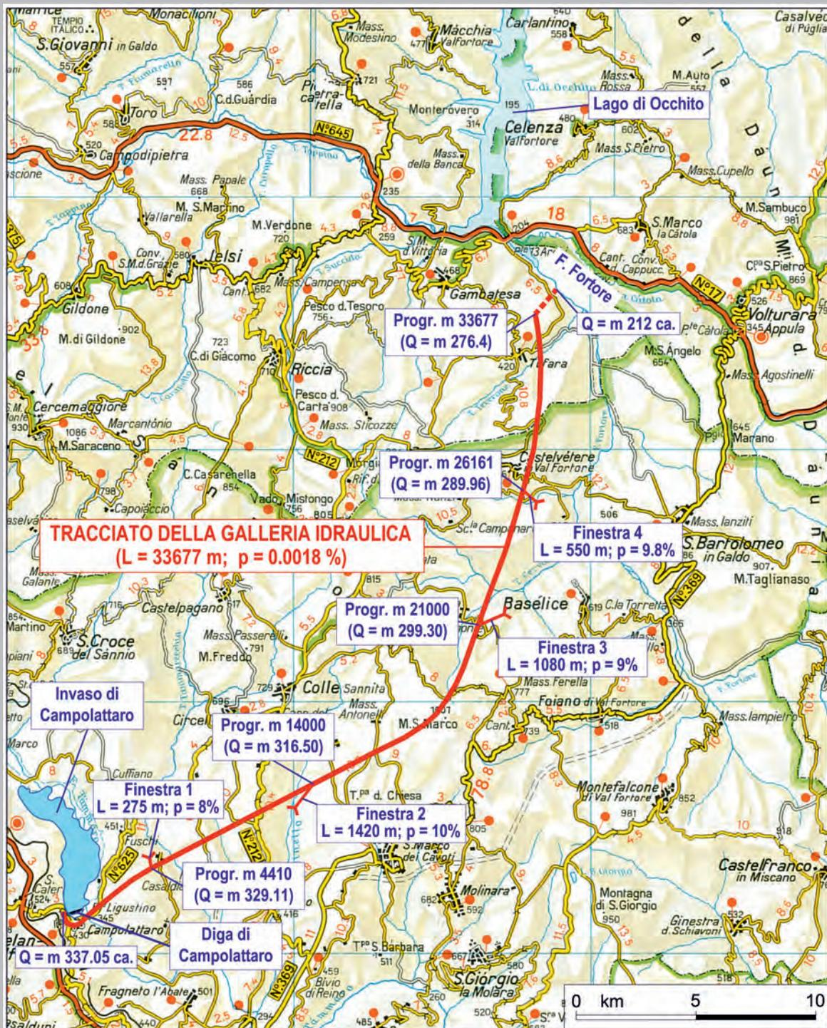
Fig. 29.3 - Planimetria con ubicazione dell'invaso di Campolattaro e del relativo collegamento all'invaso di Occhito nel F. Fortore.
