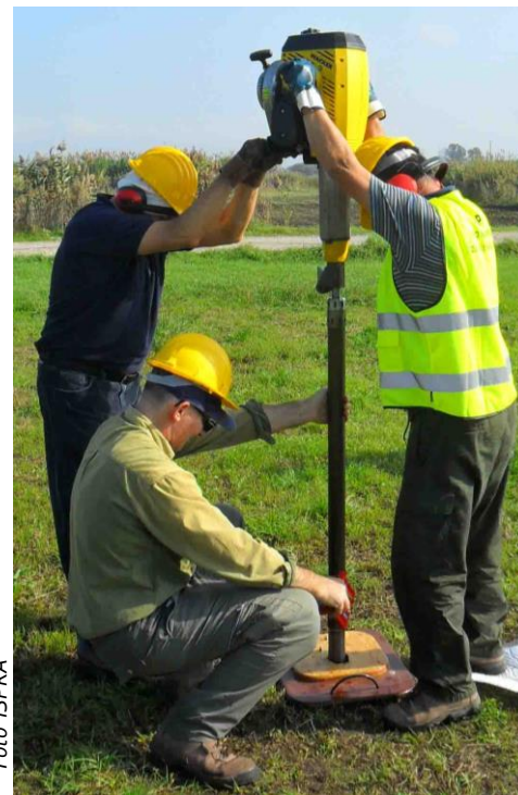
Sondaggio con trivella a motore Linea 6a
