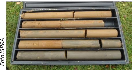
Sondaggio profondo a carotaggio continuo
