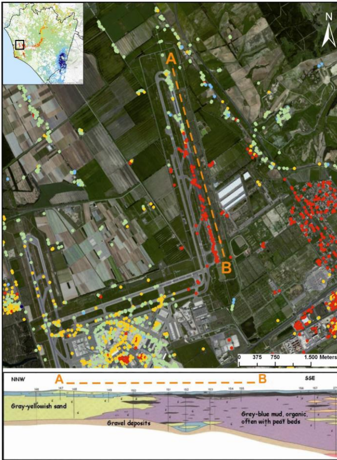
Aeroporto di Fiumicino: subsidenza su terreni compressibili
