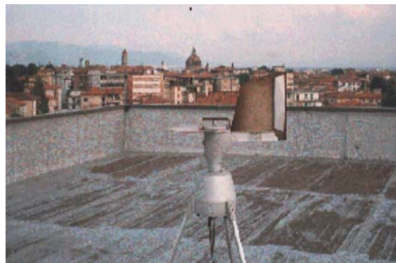
Figura A2.1 - Campionatore volumetrico VPPS 2000 della stazione di Pistoia
