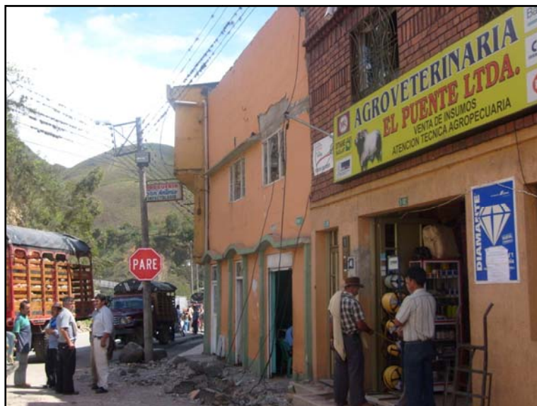
Fotografía 5.24. Caída de fachadas y fisuras en locales afectados en Pte. Quetame.
