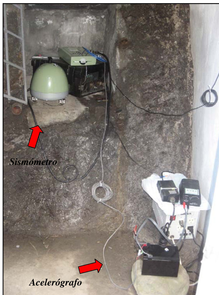
Figura 3.7. Detalle de la instalación de la estación sismológica portátil en Quetame, donde también está instalado un acelerógrafo, como puede verse.
