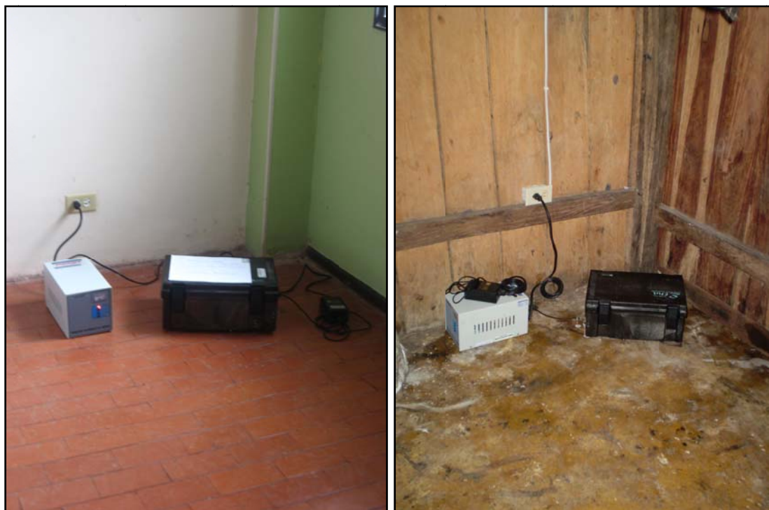
Fotografía 3.1. Ubicación de las estaciones portátiles de acelerógrafos de Quetame (izquierda) y Acacias (derecha, instaladas a partir del sismo de Quetame.
