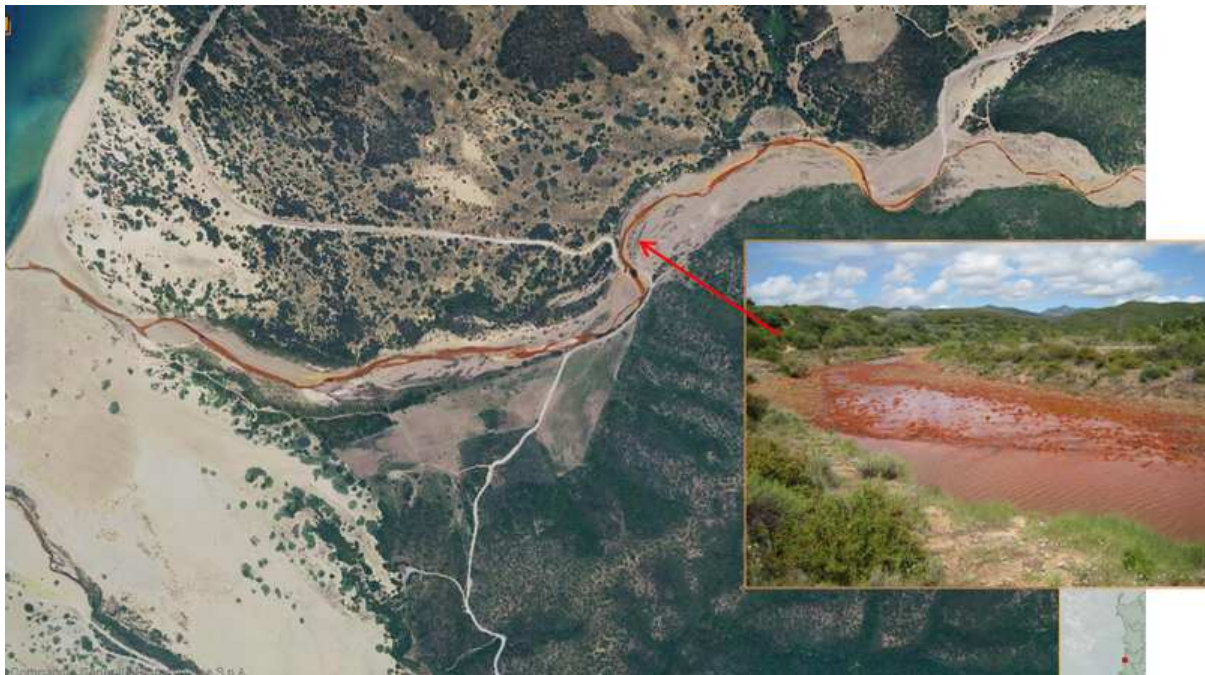
Figura 3.9 Rio Piscinas e Rio Irvi: esempio di presenza di AMD (Sardegna occidentale). Foto aerea tratta dal geoportale del sito www.regione.sardegna.it con particolare fotografato eseguito in situ.
