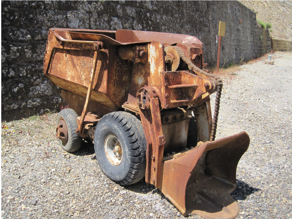
Figura 2.1 Autopala Montevecchio T2G, esposta presso la Miniera di Montevecchio (Sardegna). Tale macchinario fu studiato, progettato e costruito presso quella miniera e si diffuse poi rapidamente in molte altre per lavorare in galleria. Essendo gommata non necessitava dei binari, permettendo maggiore facilità di manovra nelle gallerie strette e tortuose delle miniere. Fu ideata da Letterio Freni, capofficina della miniera.
