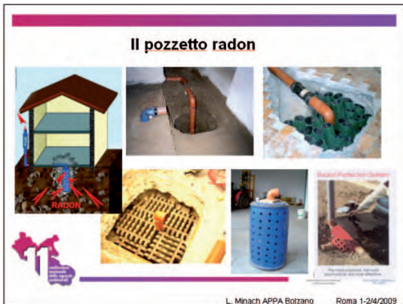
Figura S2.8.2 - Il pozzetto radon.
