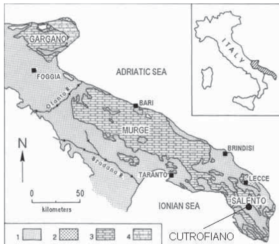
Fig. 1 - Carta geologica schematica della Puglia ed ubicazione di Cutrofiانو: Legenda: 1) coperture clastiche recenti (Pliocene - Pleistocene); 2) rocce carbonatiche bioclastiche (Paleogene) e calcareniti (Miocene); 3) rocce di piattaforma carbonatica (Giurassico sup. - Cretaceo), 4) rocce carbonatiche, con selce, di scarpata e bacino (Giurassico sup. - Cretaceo).
