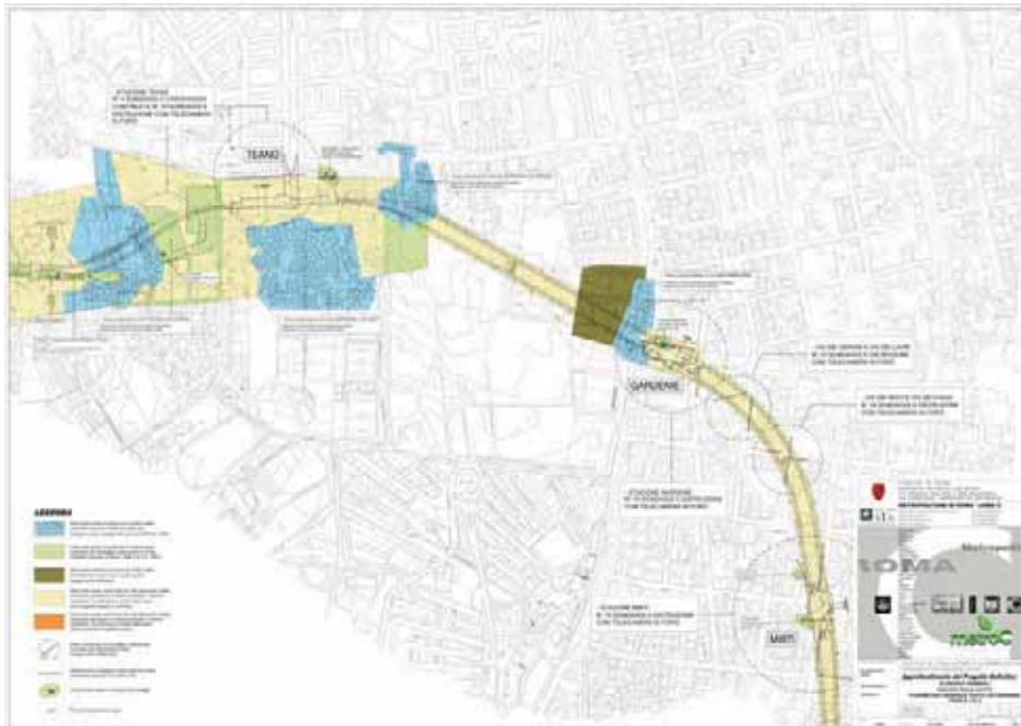
Fig. 5 - Linea C. Tratta T5. Planimetria generale cavità sotterranee [STA-Prof. Geol. M. Sciotti]
