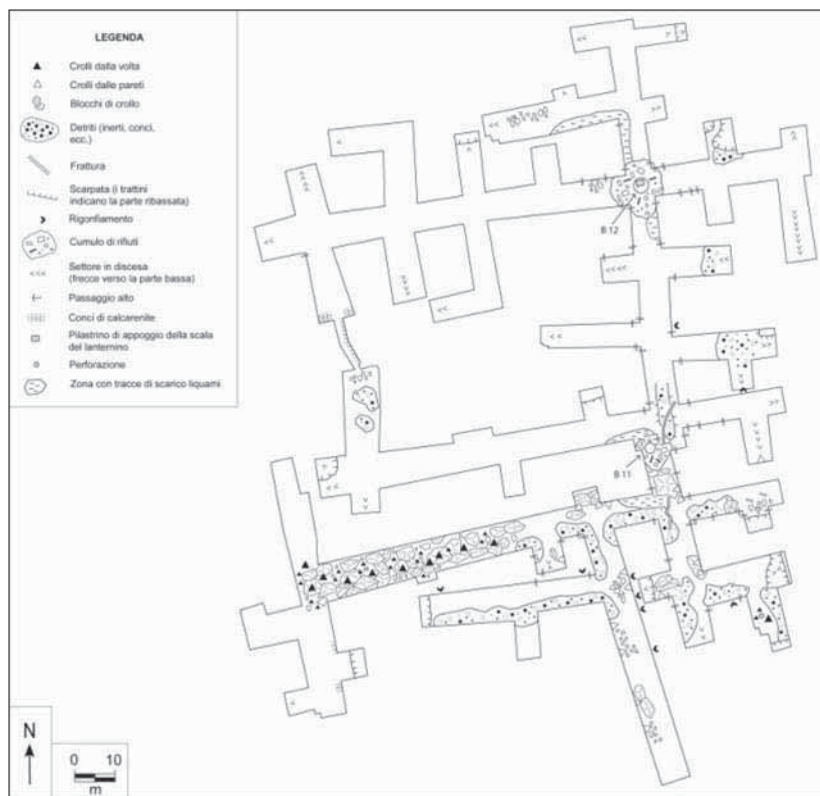
Fig. 3 - Esempio di planimetria delle gallerie scavate nell'area a sud di Cutrofiano, con indicazione delle aree soggette a dissesto
