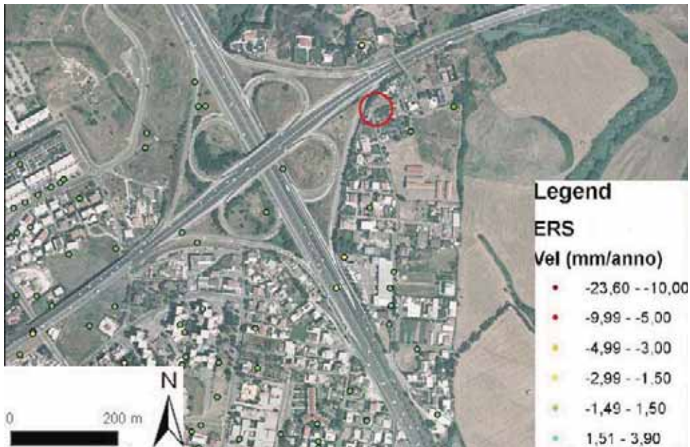
Fig. 11 - Sinkhole a Via Galatea [cerchio rosso]: distribuzione dei PS ERS ascendenti [periodo 1993-2000].
