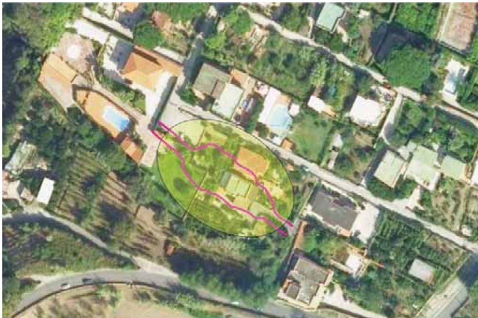
Fig. 7 - Simulazione del crollo della volta della cavità attraverso l'applicazione di una procedura FEM incrementale: in evidenza l'area interessata dallo sprofondamento in superficie.
