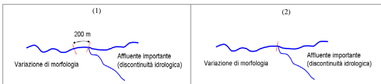
Figura A4.18 – Nei casi in cui un'applicazione rigida dei criteri di suddivisione porterebbe ad un'eccessiva frammentazione dei tratti, si applica un criterio di predominanza. (1) Esiste una discontinuità idrologica e, 200 m a valle, l'alveo varia la morfologia (da sinuoso a meandriforme), pertanto l'applicazione rigida dei criteri precedenti porterebbe a delimitare un tratto con lunghezza di 200 m; (2) si assume la discontinuità idrologica (affluente) come il criterio predominante, pertanto i 200 m a valle della confluenza vengono inglobati nel tratto a valle con morfologia meandriforme.
