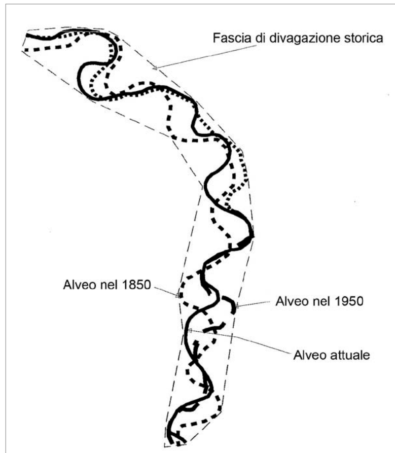
Figura 8.4 – Definizione della fascia dei meandri attraverso l'analisi storica (modificata da MALAVOI et al., 1998 ).
