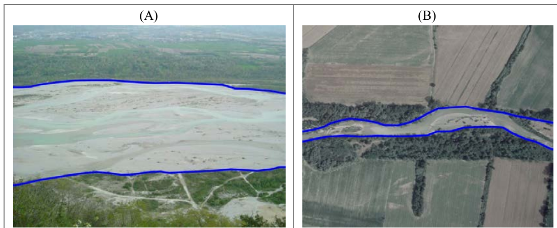
Figura 4.6 – Delimitazione dell'alveo per corsi d'acqua sufficientemente larghi (larghezza > 30 m). Le linee blu rappresentano le sponde dell'alveo. (A) Esempio relativo a un tratto del fiume Tagliamento; (B) Esempio relativo a un tratto del fiume Cecina.
