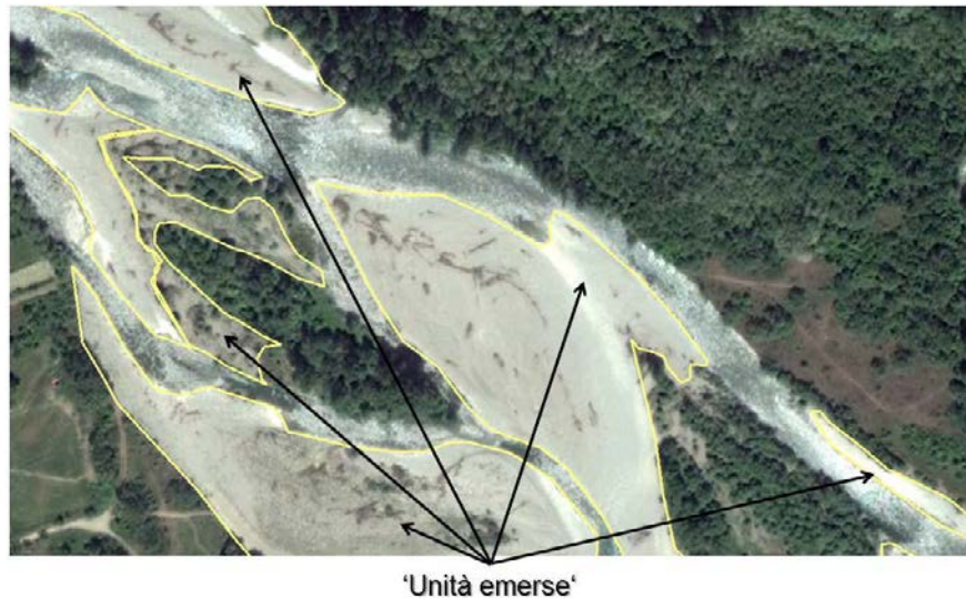
Figura 7.2 - Esempio di macro-unità "unità emerse" (E).
