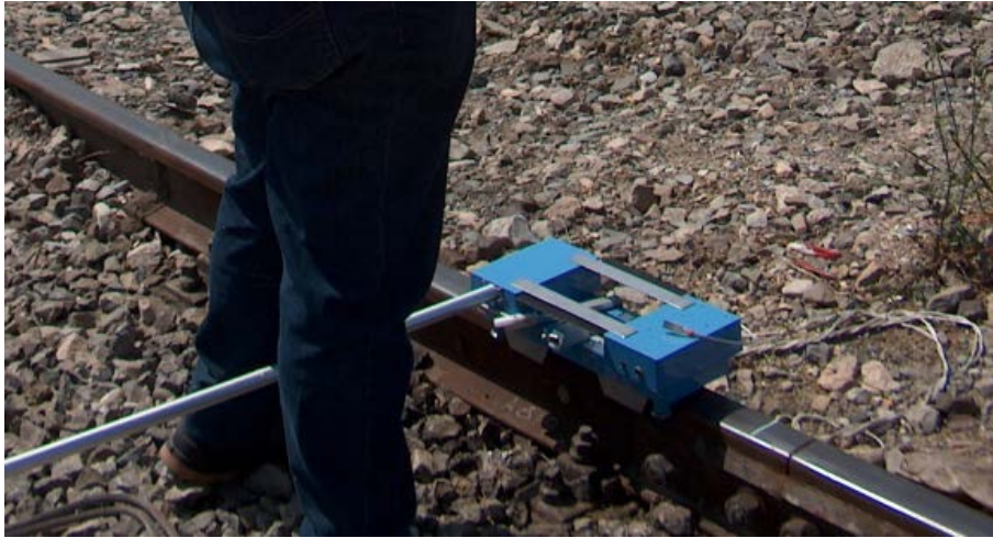
Figura 8. Particolare della strumentazione di misura della rugosità CAT.
