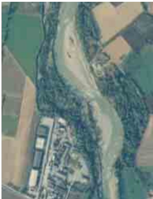
Figura 6.2.1: Le "lunate", erosioni a forma di falce di luna, in una fotografia aerea del tratto di Sangone a Rivalta di Torino dopo la piena dell'ottobre 2000. La corrente proviene dall'alto verso il basso della fotografia e si vede chiaramente l'erosione prima della sponda destra, poi della sinistra con la tipica forma a falce di luna. Si osservino anche, le tracce di precedenti erosioni di sponda, ricolonizzate dalla vegetazione, di cui quella in sponda sinistra (sulla destra della foto) di nuovo a chiara forma di lunata. Sulla sponda destra (a sinistra della foto) la profonda erosione, ormai colonizzata da vegetazione d'alto fusto, aperta nella piena del settembre 1981.
