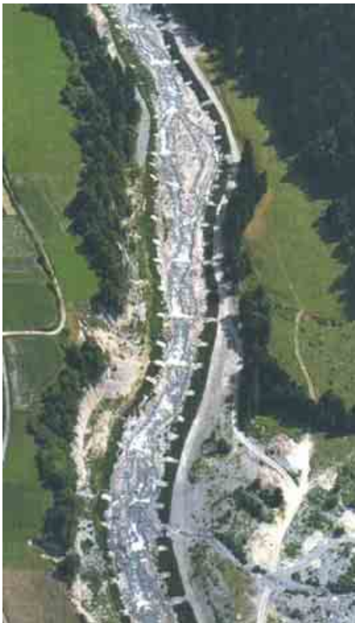
Figura 6.2.6: Immagine di una sistemazione a pennelli in pietrame, ortogonali alla corrente realizzata sul Rio Ram a Tubre dall'Azienda Speciale per la Regolazione dei Corsi d'Acqua e la Difesa del Suolo. E' scelta una soluzione adatta ad un corso d'acqua con trasporto grossolano adottando repellenti corti e ravvicinati.
