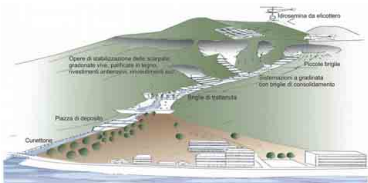
Figura 1.6.1: Rappresentazione schematica delle opere di difesa di un centro abitato con particolare riferimento alla protezione dalle colate detritiche secondo la tecnica giapponese (da HBJLS, 1985) riportato da Seminara e Tubino (modificato).
